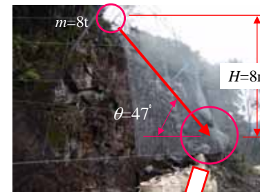
この防護ネットのエネルギー吸収性能は120kJ程度
