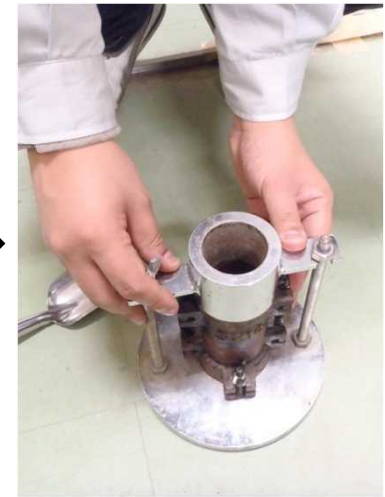
底盤とカラーを設置する。
