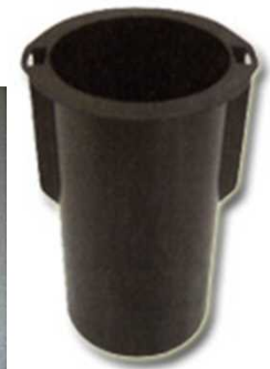
モールド ( \phi 50\text{mm} , h 100\text{mm} )
