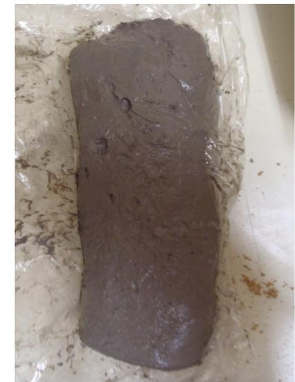
供試体が自立せず、計測不能という残念な結果に。コメントにあるように、含水比が大きすぎましたね…
