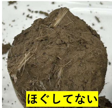
繊維/セメント改良試料の圧縮試験後の写真
