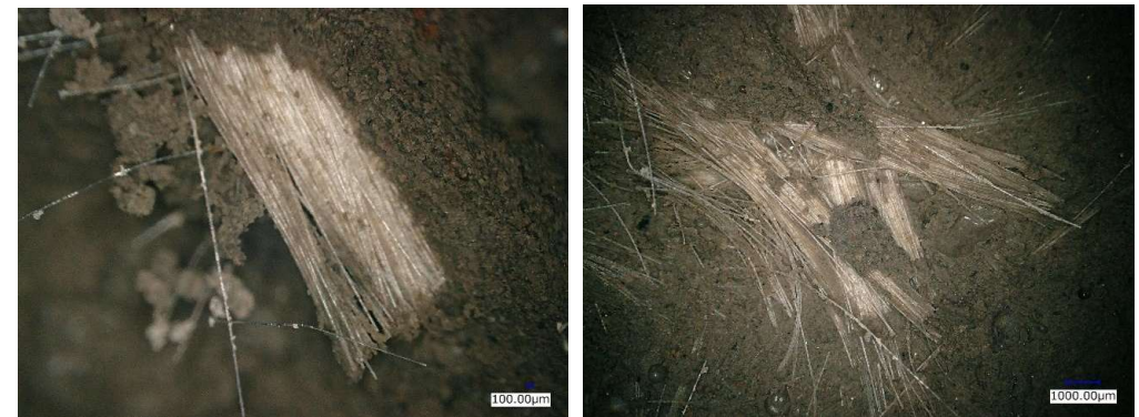
繊維がほぐしてない繊維/セメント改良試料の顕微鏡画像
