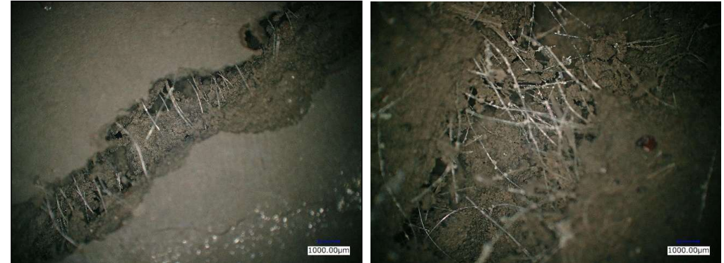
繊維が適切にほぐした繊維/セメント改良試料の顕微鏡画像
