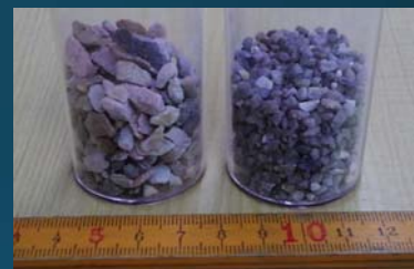
地盤材と間詰材
