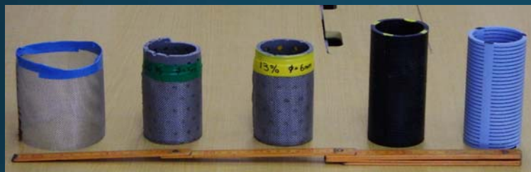
疑似ボーリング孔とストレーナ管
