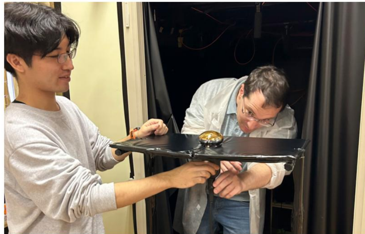
試作品の外水槽用光センサーを試験用のホルダーに設置
