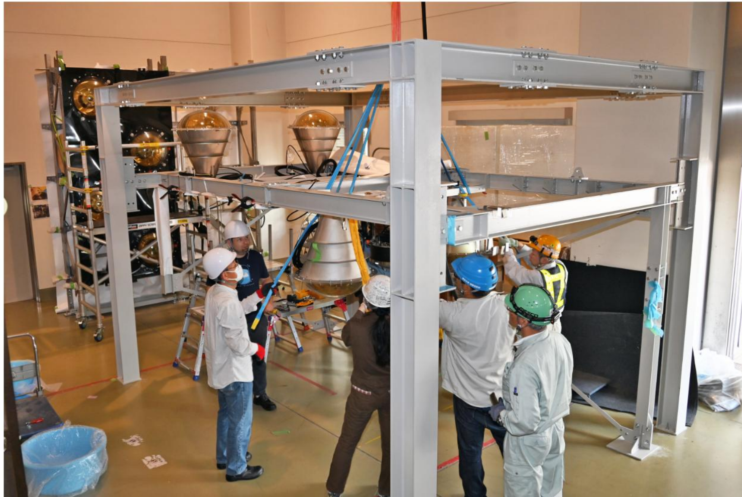
ハイパーカミオカンデと同じ設計の試験フレームへの光センサー取り付けのようす 宇宙線研究所・北棟1階の共同実験室で
