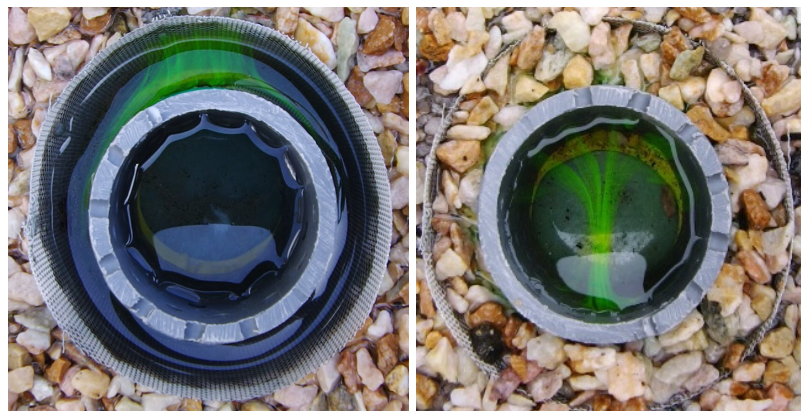
図-8 可視化した観測孔内の水の流れ
