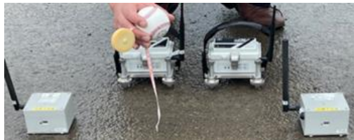
図-6 トリガー加振状況
