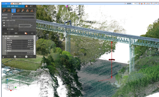
図-1 路線測量で取得した地形データ
