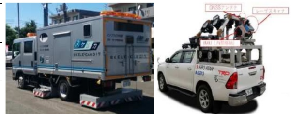
写真-1 地中レーダ探査車両と MMS 測量用車両
