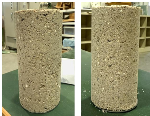
図 4 供試体（左：含水比15%，右：含水比10%）
