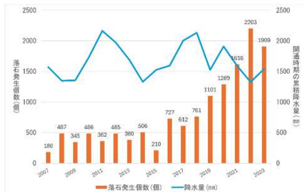
図1 落石発生個数と降水量の関係
