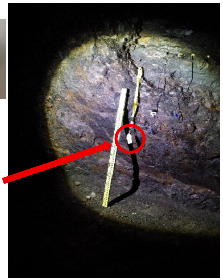
図6 亜炭廃坑奥に設置したデータロガー
