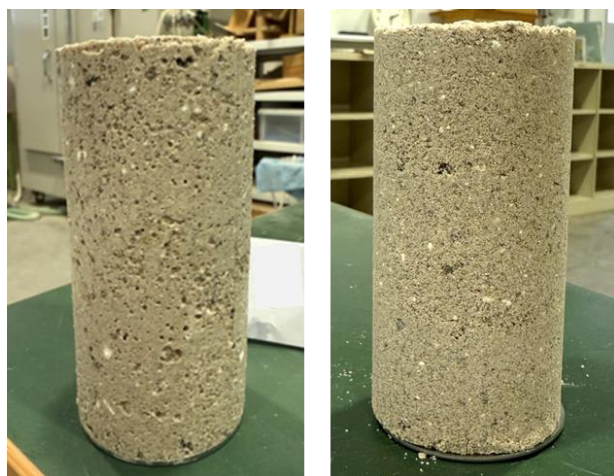
図 4 供試体 (左: 含水比15%, 右: 含水比10%)
