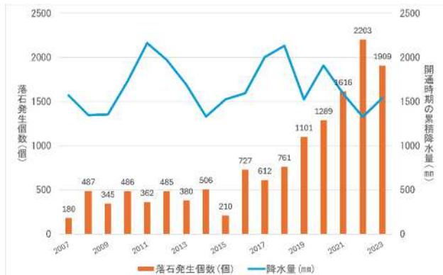
図1 落石発生個数と降水量の関係
