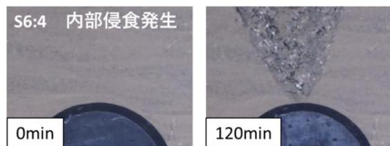
図 8 内部侵食発生時の欠損近傍の様子
