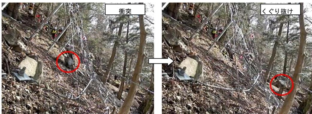
写真-3 落石減勢工衝突前 (落石No.C)
