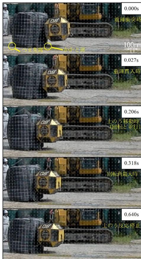
図-9 衝突時の土のうの反応状況 (No. 3)
