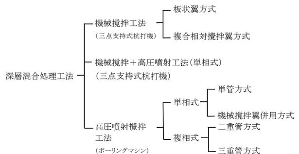
図-1 地盤改良工法における固結工法の分類
