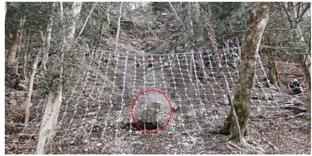
写真-2 落石減勢工衝突時の状況 (落石No.A 捕捉時)
