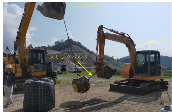
写真-4 振り子による重錘衝突実験の状況
