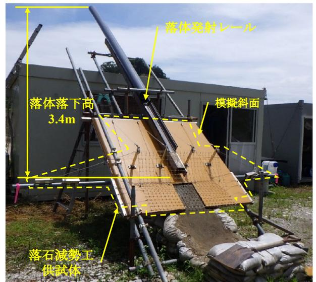
図-1 縮小モデル実験の装置概要図
