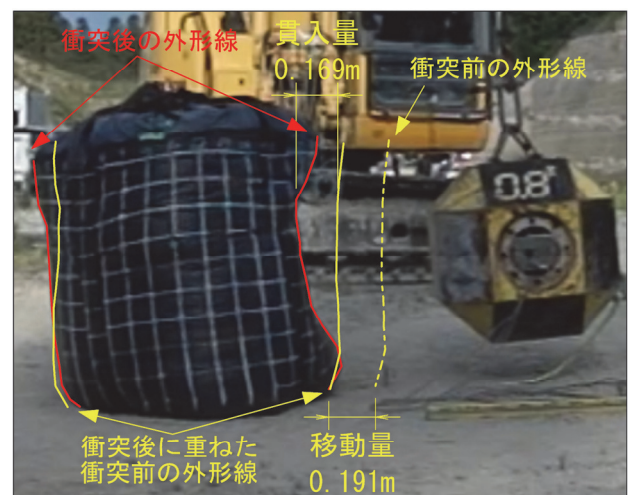
図 4 ケース 4 の衝突後の貫入量と移動量の計測結果
