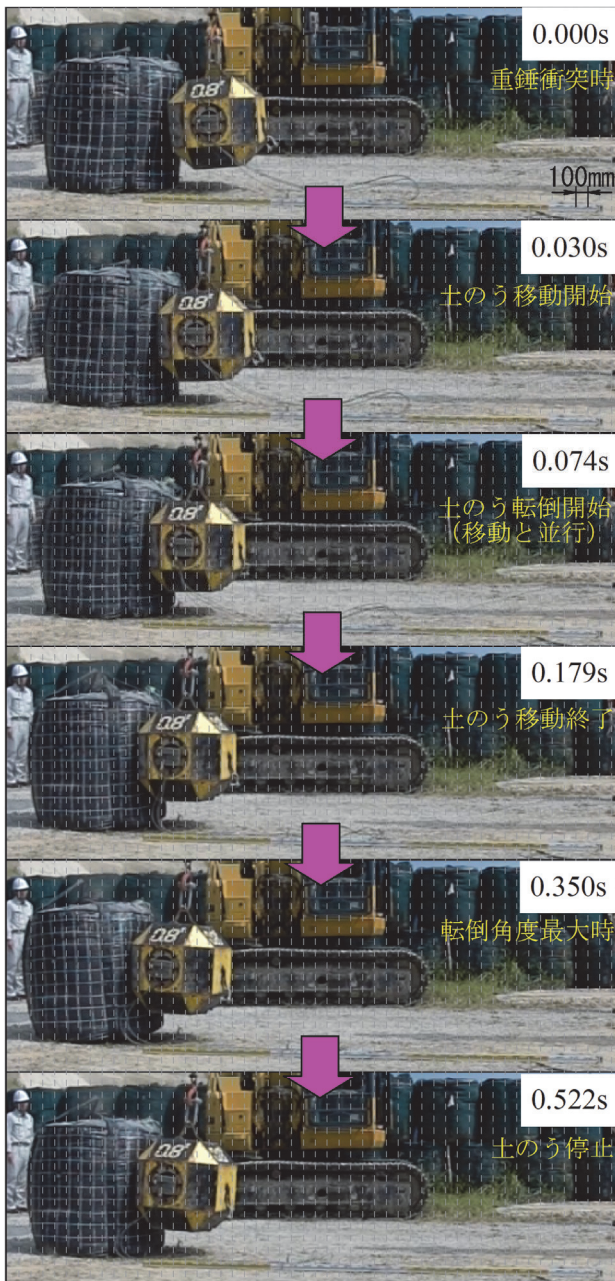
図 3 ケース 3 における土のうの各反応状況
