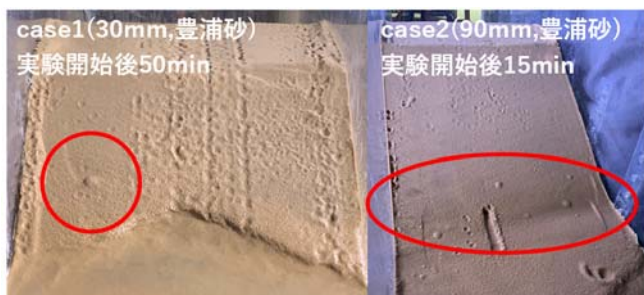
図5 実験で確認されたエアブロー現象：左図；case1 (降雨強度 30mm/h, 豊浦砂), 右図；case2 (降雨強度 90mm/h, 豊浦砂)
