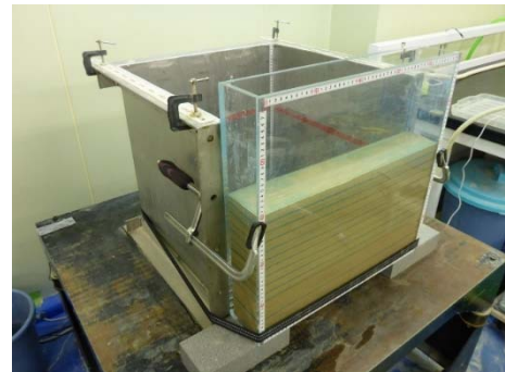
図3 簡易振動台実験装置
