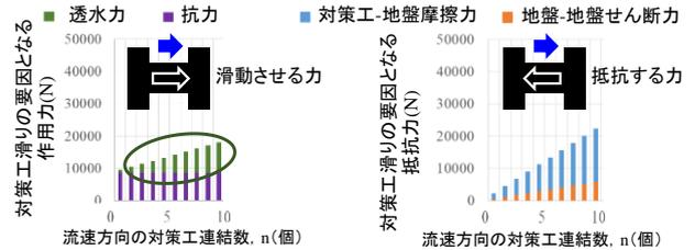
図 22 対策工の連結数-滑動を促す力及び妨げる力の関係
