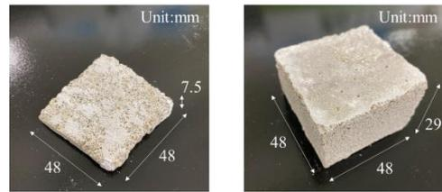
図 9 平板型模型及び箱型模型
