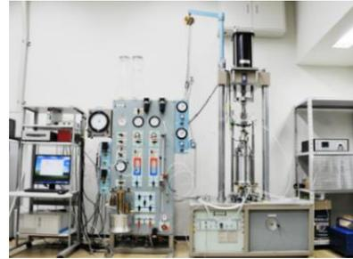
図3 高温中容量三軸試験機
