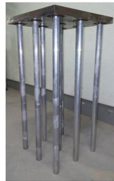
図 2 パイルドラフト模型
