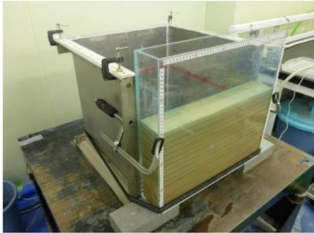
図1 簡易振動台実験装置<sup>11),12)</sup>
