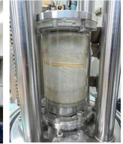
図4 圧力セルの詳細
