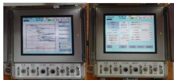
図1 統合型管理装置の計測画面（左：支持層、右：数値）
