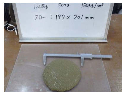
(a) シリンダーフロー (C.F.=約200mm)
