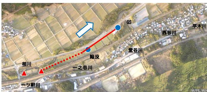
図8 マンボAの取水口（写真）（国土地理院地図に加筆） （取水口（▲）：左から 相川・一ツ軒川，他の位置（●）：左から 陥没・GS，マンボの旧水路：——が陶管ルート，……が推定ルート）
