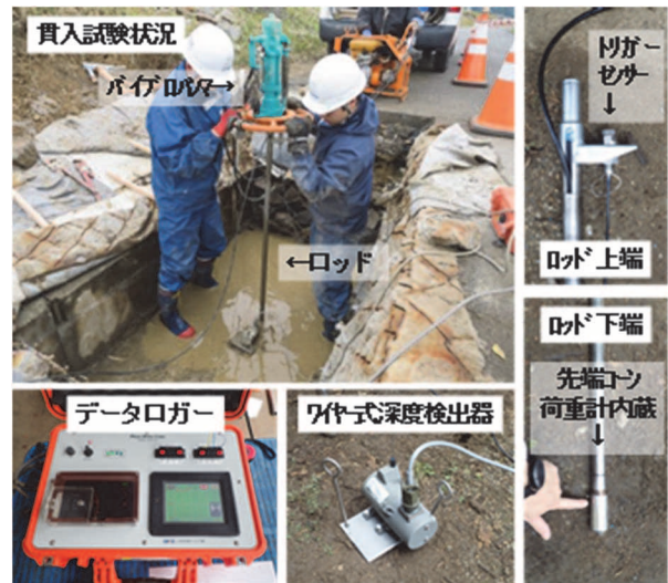
図 13 パイプロコーン試験装置の様子
