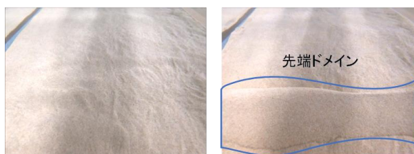
図10 先端ドメイン(左:すべり発生前, 右:すべり発生後)
