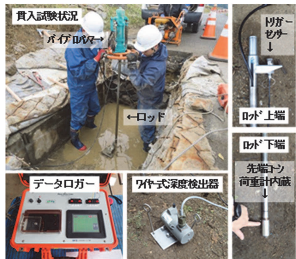
図 13 パイプロコーン試験装置の様子
