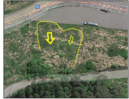
写真-2 崩壊前の盛土のり面
