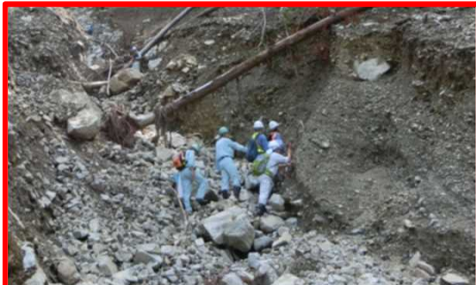
溪床に堆積した礫・侵食状況
