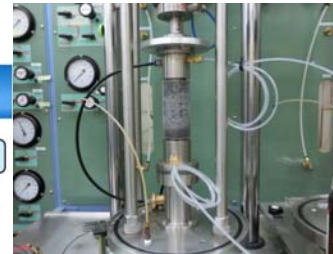
供試体を三軸セルにセット
