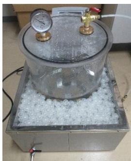
図 4 脱気水槽と恒温槽
