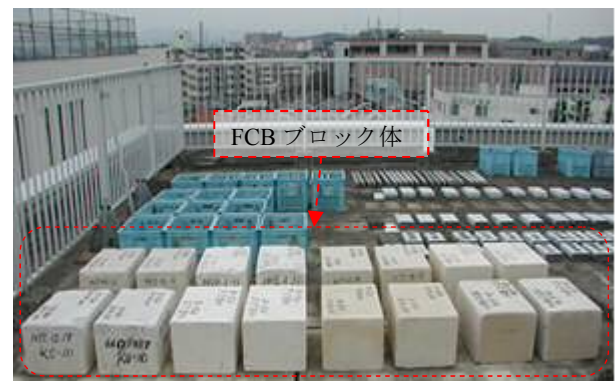
写真-1 FCBブロック体の暴露養生状況
