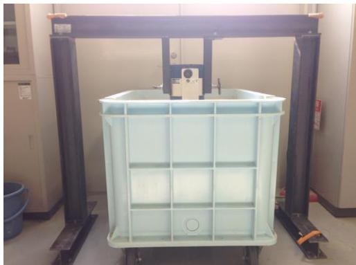
写真-7 小型振動装置の全体像
