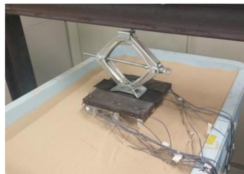
写真-4 ラフトと地盤を接触するための模型パイルド・ラフトの貫入
