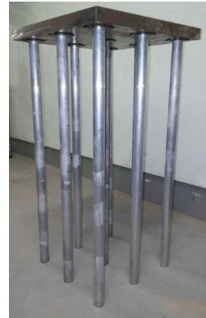
写真-2 パイルド・ラフト模型
