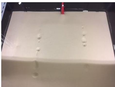
図 15 Case4 加振後の地表面の様子
