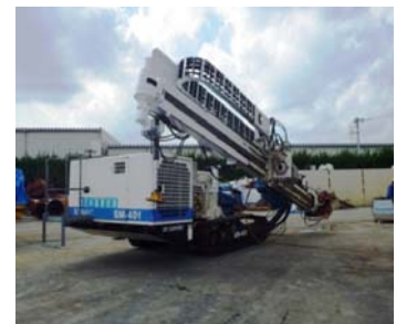
写真-1 ロングフィード式ボーリングマシン
