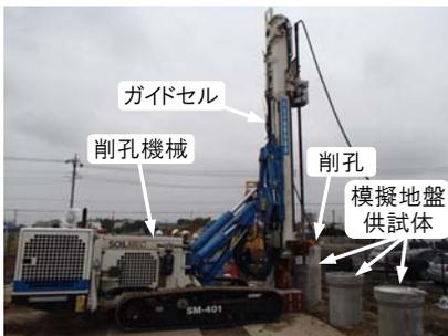
写真-3 模擬地盤での削孔試験状況
