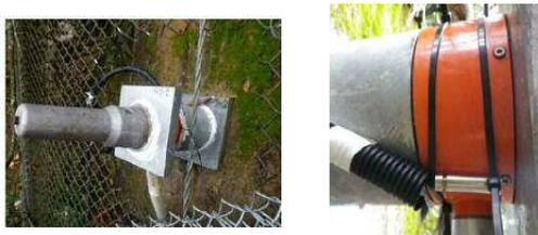
写真-5 向山TN北坑口における荷重計設置状況
